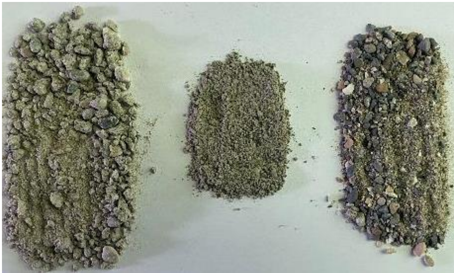
Beispiel Zementestrich, MV 1 : 6
