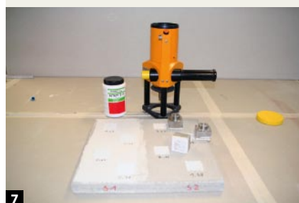
7 Systemkomponenten wie Grundierung und Abdichtung werden in die Haftzugprüfungen einbezogen.
