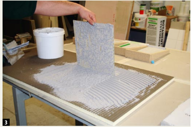
3 Mit einer einfachen Prüfung wird im Labor die Benetzung bestimmt. Später muss der Mörtel auch die nötige Offenzeit nachweisen.
