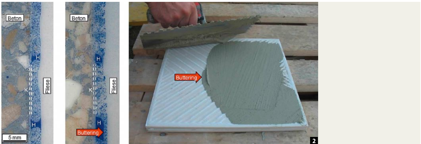
2 Die Dünnschliffe wurden quer zum Verbund Betonwand-Feinsteinzeugfliese mit dem Klebemörtel dazwischen erstellt. Hohlstellen (H) und Poren sind blau eingefärbt. Auf dem linken Bild grenzen die Hohlstellen direkt an die Fliese. Hier wurde nicht im Buttering-Floating-Verfahren verlegt. Im mittleren Bild ist zu erkennen, dass die Butteringschicht einen satten Verbund zur Fliese ermöglicht hat. Die Hohlstellen reichen nicht bis direkt zur Fliesenrückseite. In beiden Dünnschliffen ist die dünne Kratzspachtelungsschicht (K) auf dem Betonuntergrund sichtbar. Das rechte Bild zeigt das Aufspachteln einer Butteringschicht, bevor die Fliese eingelegt wird.
