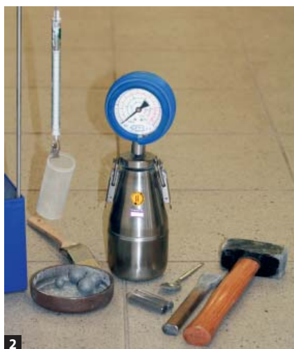
2 Gerade für Großformate muss der Untergrund trocken und belegereif sein. Die CM-Messung sollte sorgfältig durchgeführt werden.
