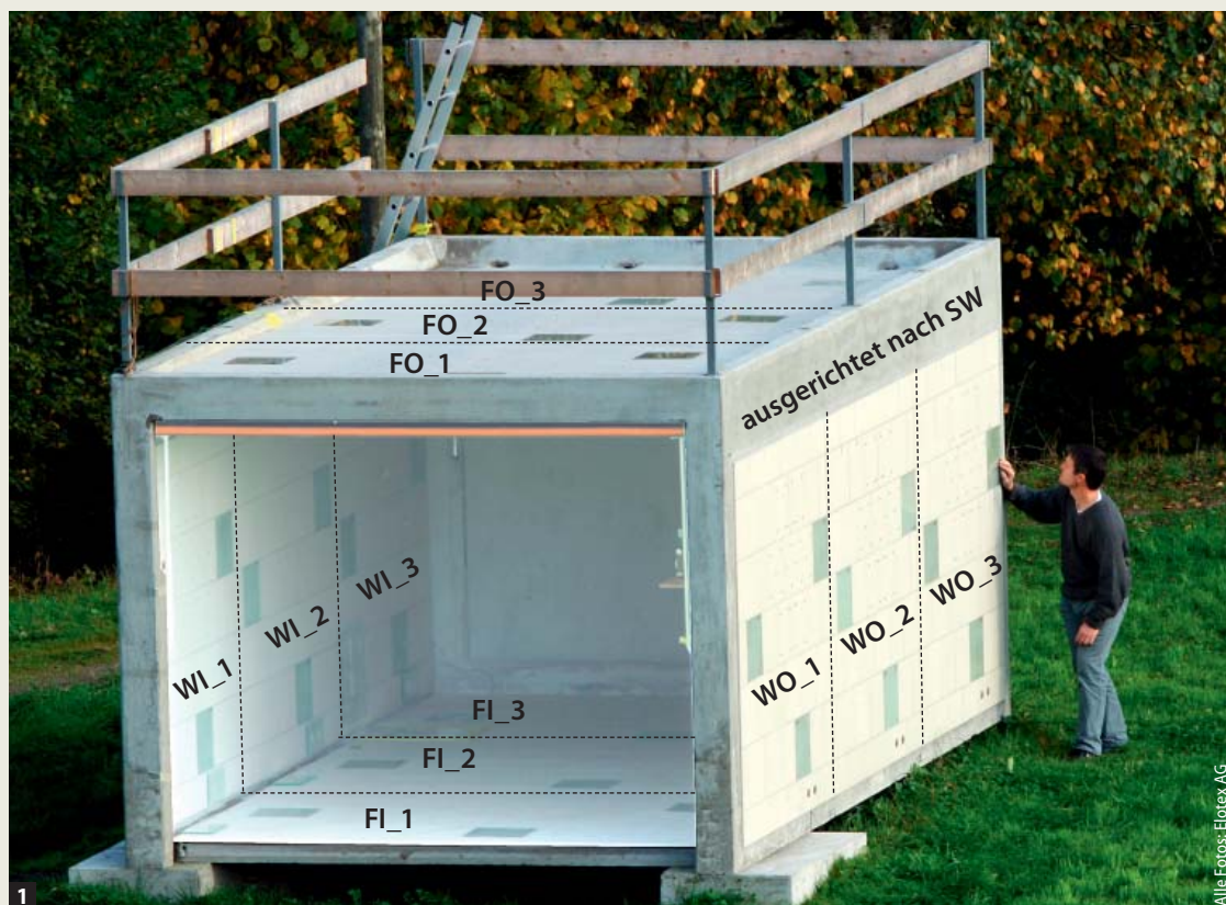
1 Die Wände und Böden einer Fertiggarage dienen als Testflächen im Innen- und Außenbereich. Jede Testfläche wurde in drei Sektoren eingeteilt, in denen jeweils verschiedene Mörtelsysteme und Verlegetechniken angewandt wurden.
